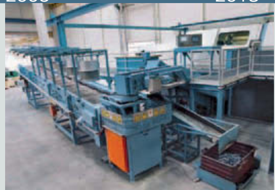
Liegende, mechanische Mehrstufenpresse Taktzeit 0,8 – 1 Sek.
