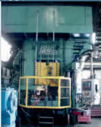
Hydraulik-Pressen Taktzeit 7 Sek. Presskraft 400 t
