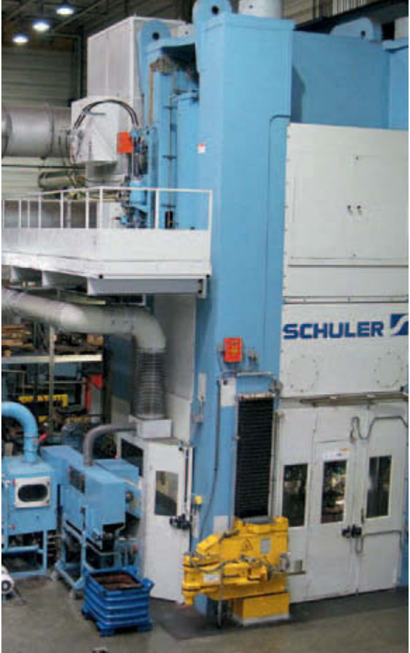
5-stufige vollautomatische Kaltpresse
