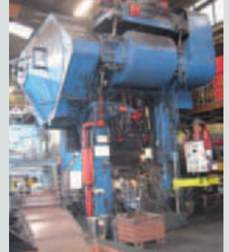
Kurbelpresse handbedient Taktzeit 10 – 20 Sek.
