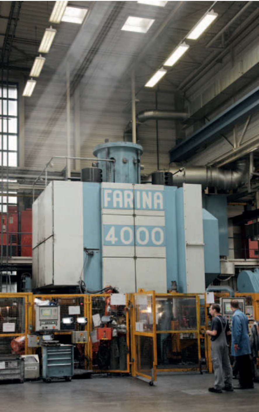
4-stufige vollautomatisierte Warmumformpresse
