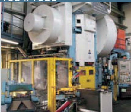
Kurbelpresse vollautomatisiert Taktzeit 2,5 – 6 Sek.
