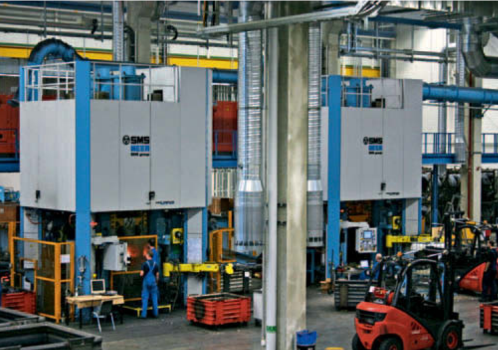
4-stufige vollautomatisierte Warmumformpresse
