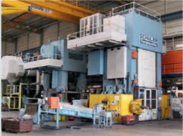
Exzenterpresse Taktzeit 2,5 Sek. Presskraft 2.000 t
