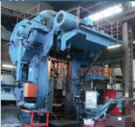
Exzenterpresse Taktzeit 2,5 Sek. Presskraft 1.600 t
